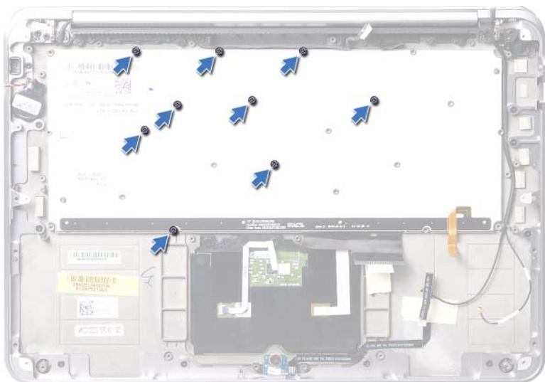
5 Levante el teclado para extraerlo del ensamblaje del reposamanos.
